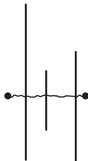
ب – اتصال پاپیونی: در این روش نخست قطعه مفتول نازکی را به شکل پروانه یا پاپیون در می‌آوریم. سپس با قرار دادن واشر در میان قطعات موردنظر، قطعه مفتول را از سوراخ آن‌ها عبور داده و در طرف دیگر برمی‌گردانیم. از میخ‌های سراجی دو سر تیز می‌توان استفاده کرد.
